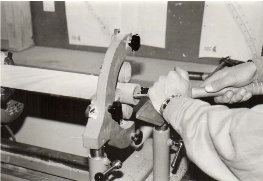
Die Vertiefung für den Schallbecher wird ausgedreht.
