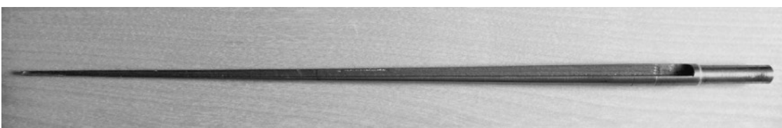
Anstelle der Bohrer wird nun der konische Räumler (Ausreiber) ins Bohrfutter eingesetzt. Er ist auf den entsprechenden Konus der Bohrung handgeschmiedet.
